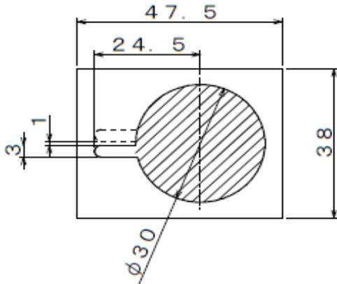
図2. 印刷電極付き高分子圧電フィルム 標準品 [ pp1-XX- シリーズ ] 円形パターン各品番概略図 (単位 mm)
