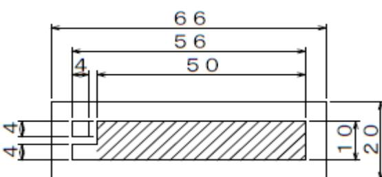
図1. 印刷電極付き高分子圧電フィルム 標準品 [ pp1-XX- シリーズ ] 矩形パターン各品番概略図 (単位 mm)
